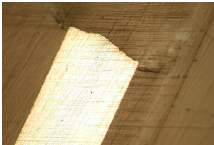
Metalografický výbrus leptané šablony s ukázkou typického „zobáčku“ ve středu a s mírně kónickým tvarem otvoru pro lepší uvolňování pasty. Síla plechu je 150 \mu\text{m}
