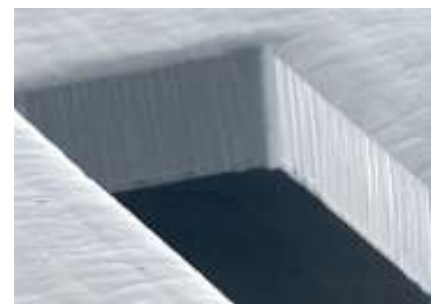
typický tvar otvoru electroformingem
