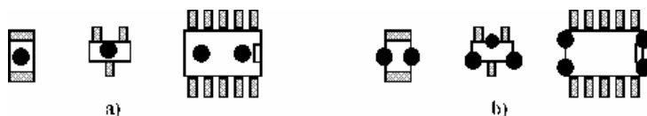
Obr.3.9: Lepicí body při vytvrzování teplem a) a ultrafialovým zářením b).
