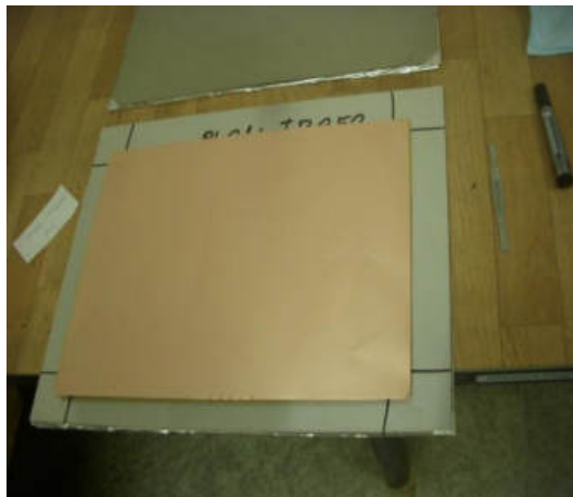
Obr. 23: Měděná fólie v paketu.
