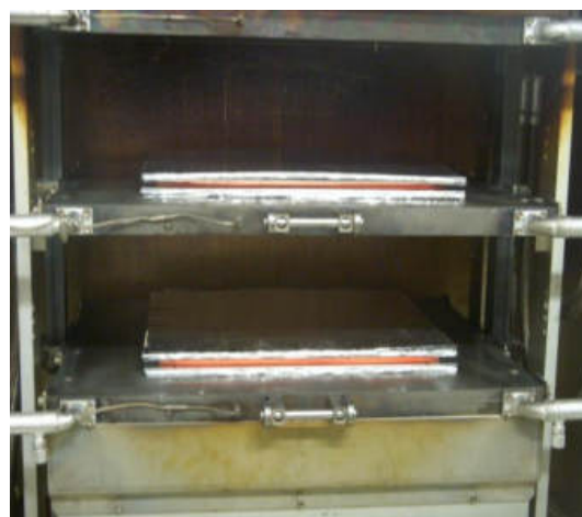
Obr. 25: Pakety ve vakuovém lisu.
