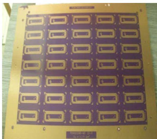
Obr. 33: Vyvolaný negativní motiv.
