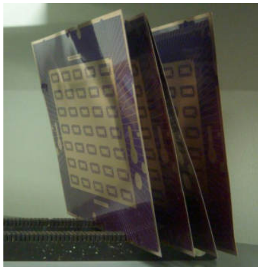
Obr. 14: Vyvolané vnitřní vrstvy před leptáním.
