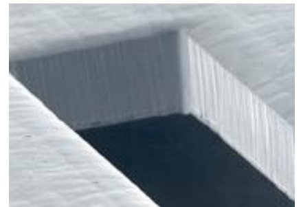
typický tvar otvoru electroformingem
